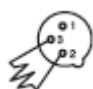
Der Abschlusswiderstand reduziert Signalfehler und verhindert Probleme und Störungen bei der Signalübertragung. Es ist immer empfehlenswert, ein DMX-Abschlusselement (120 Ohm 1/4 W Widerstand) zwischen den PIN 2 (DMX-) und PIN 3 (DMX +) des letzten Scheinwerfers zu benutzen. Abbildung 4
